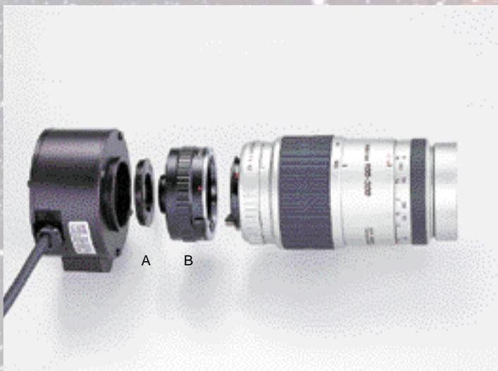
STVは、望遠レンズ撮影にも大いに向いています。C Tアダプターリング(A)とCマウントアダプター(B)のオプションパーツ使用で、殆どすべてのメーカーのものに対応します。写真は、PENTAX Kマウントの300mm望遠レンズ掲載
