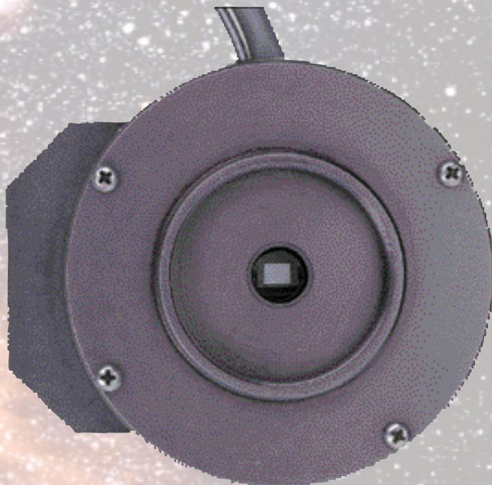
一段空冷ペルチエー装置内蔵のため、本格的な天体イメージングは極めてローノイズで0.001秒から最大600秒までの露光可能。チップ面積6.9×4.6mm(656×480画素、16ビットA/D変換)。CCDヘッドの雌Tネジで、お手持ちのカメラマウントへ直接接続できます。
